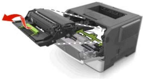
**警告—可能的损坏：** 请勿触摸感光鼓。否则会影响以后打印作业的打印质量。
